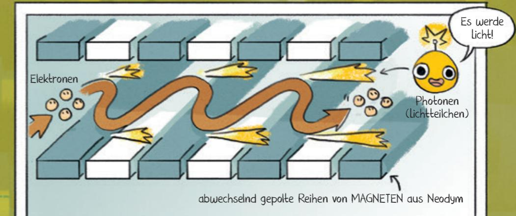
Mit Hilfe von Magneten bringen wir die Elektronen hier auf einen Zick-Zack-Kurs. Bei jeder Richtungsänderung geben sie nämlich einen Teil ihrer Bewegungsenergie in Form von Licht ab. Das Licht regt die benachbarten Elektronenpakete zusätzlich an. So entstehen am Ende extrem helle Lichtblitze, die nur wenige Femtosekunden lang sind.
