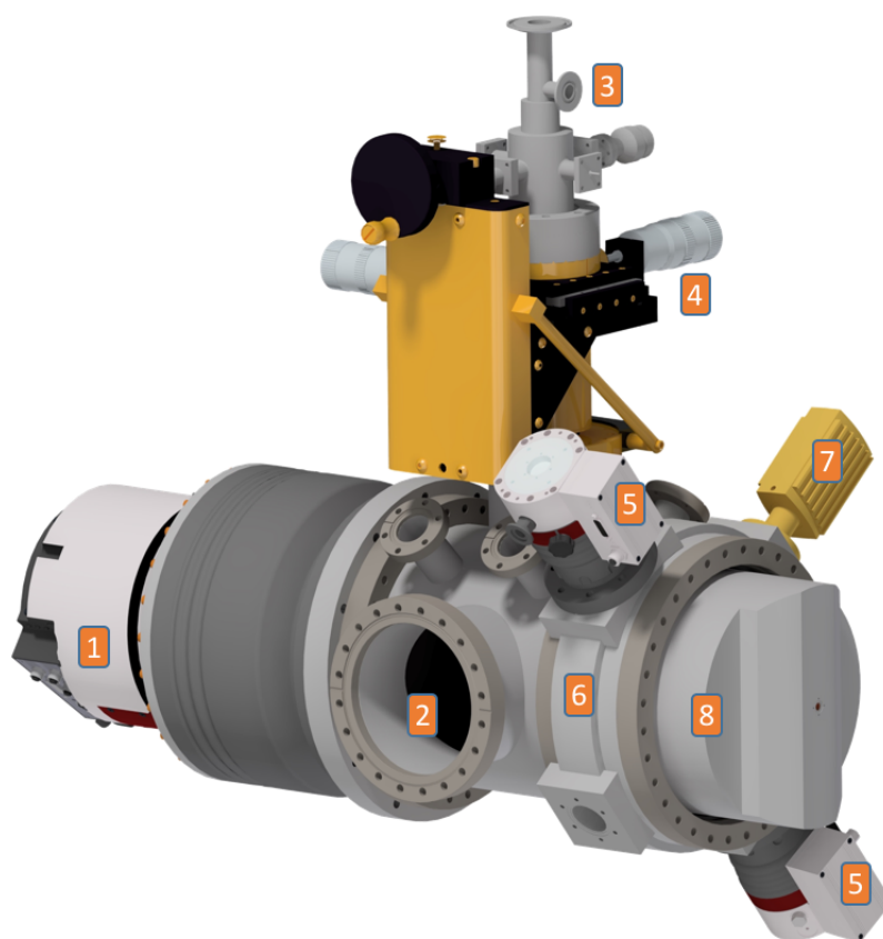
Abbildung 2.4: Koaxial aufgebautes, zweistufig differentiell gepumptes Jetsystem, welches an der DN300CF-Kammer verbaut wurde. 1: Turbomolekularpumpe mit 2300 l/s Saugvermögen für die erste Expansionsstufe. 2: Expansionskammer in DN250CF. 3: He-Durchflusskryostat zur Kühlung der Düse. Nicht zu sehen ist der Düsenhalter mit Düsen, welcher am Kryostat montiert ist und sich im Inneren der Expansionskammer befindet. 4: XYZ-Manipulator zur Verfahrung der Düsen. 5: Turbomolekularpumpen der zweiten Expansionsstufe. 6: Zwischenring für zweite Expansionsstufe. 7: Vakuummesszelle in der zweiten Expansionsstufe. 8: Skimmerhalterung (Jetblende) für die zweite Expansion. Die erste Expansionsstufe befindet sich dahinterliegend. Das dazwischen befindliche Volumen ist differentiell gepumpt.
