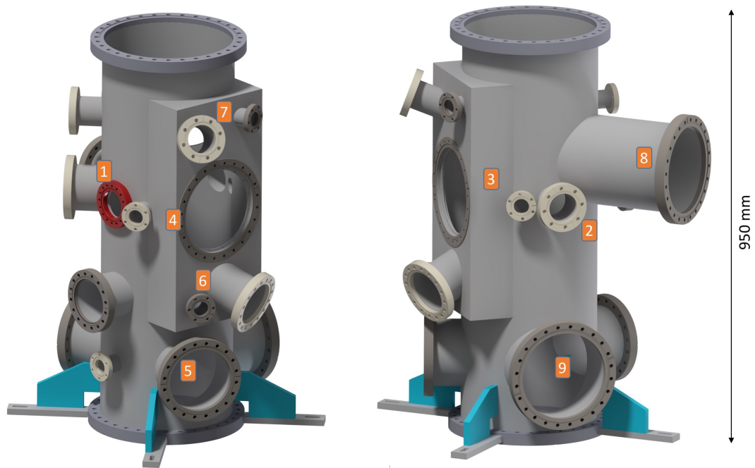
Abbildung 4.4: Zwei Ansichten der Hauptkammer des REMI-Aufbaus am European XFEL. Drehbare Flansche sind beige dargestellt. 1: Strahleingang, CF63-Spezialflansch (rot). 2: Strahlausgang (Targetebene). 3: Anbau („Kasten“) für die Montage von bis zu drei Jetstufen. Die Vakuumseite ist als große planare Dichtfläche ausgearbeitet. 4: CF200-Flansch für den Anbau der Expansionsstufen. Dieser ist direkt in die Stahlplatte eingearbeitet. 5: Zwei CF160-Ports für den Anbau von zwei Turbomolekularpumpen der 700 l/s-Kategorie für die Erzeugung des UHV im Targetbereich. 6: Pumpen- sowie Messzellenflansch für die letzte Jetstufe. Ausgelegt für eine 300 l/s-Turbomolekularpumpe für maximale Leistung des differentiellen Pumpens zum Targetbereich. 7: Pumpen- und Messzellenflansch für die vorletzte Jetstufe. Vorgesehen für eine Turbomolekularpumpe der 80 l/s-Klasse. 8: großer CF200-Stutzen für die direkte Montage einer NEG-Pumpe. Dieser Port ist besonders nah an der Targetebene angebracht worden. 9: Stutzen für die Montage einer Kühlfalle mit Titan-Sublimations-Pumpe (TSP).
